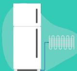
**Installez un récupérateur de chaleur sur les condenseurs.** La chaleur dégagée par les condenseurs lors de la production de froid par les groupes frigorifiques peut être utilisée pour chauffer l'eau par exemple.
